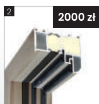
Ościeżnica aluminiowa ALU/90 trzykomorowa z podwójnym uszczelnieniem z przegrodą PCW wypełnioną pianą
