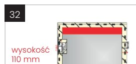
Wzmocnienie pod samozamykacz wymagane przy zakupie samozamykacza nawierzchniowego nie dotyczy wzorów Perfekt: 8, 8-1, 9, 9A, 9B Glass: 1A, 2B, 3B Glass View: 2B, 3B
